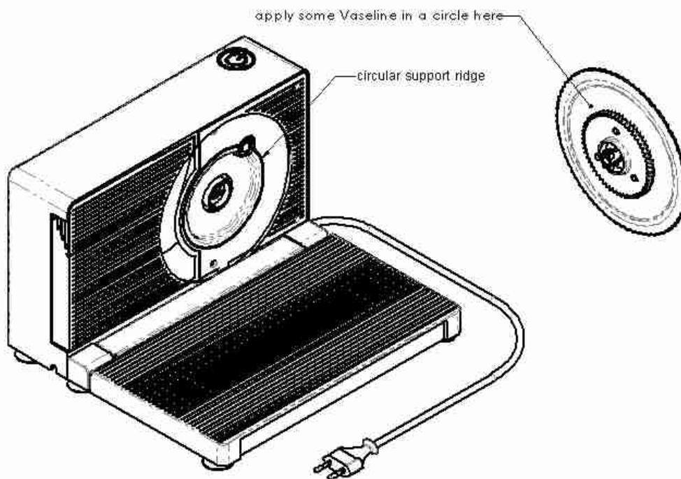
Das Sail (auch als Gegenmesser bekannt) ist die Oberfläche, die die Scheibendicke bestimmt und sich bewegt, wenn man den Dickeneinstellknopf hinten dreht. Das Gegenmesser kann auch zur Reinigung entfernt werden. Allerdings sollte man vorsichtig sein, denn wenn das Gegenmesser entfernt wird, wird die Kante der Klinge sichtbar und schafft eine Sicherheitsgefahr. Nach der Reinigung sollten Sie zur Sicherheit das Gegenmesser auf die Schneidmaschine aufsetzen.
